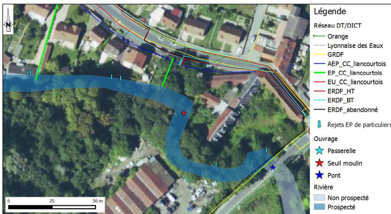
**Figure 2 : Réseaux et rejets dans la rivière au droit de la zone d'étude (Sources : DT/DICT et investigations de terrains)**
