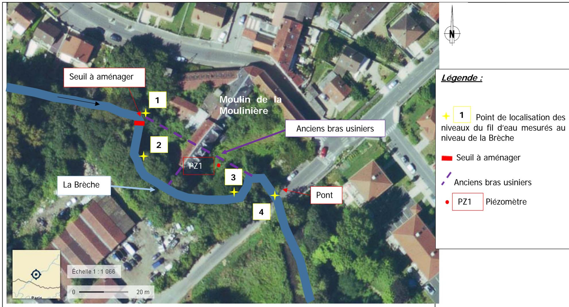
Figure 10 : Implantation des points de mesure du niveau d'eau (Source : SEMOFI)
