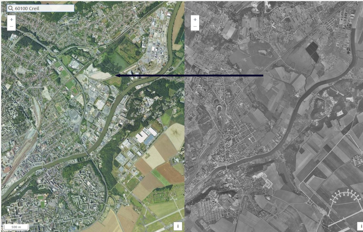
La croissance des zones urbanisées, avec l'imperméabilisation croissante des terres, entraîne une augmentation du ruissellement des pluies, aux risques conséquents : lessivage des sols, modification des écoulement, inondations, impacts sur la qualité des eaux.
