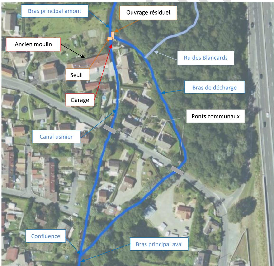
Figure 5 : Description du site hydraulique du moulin de la Commanderie (source Géoportail orthophotographies)
